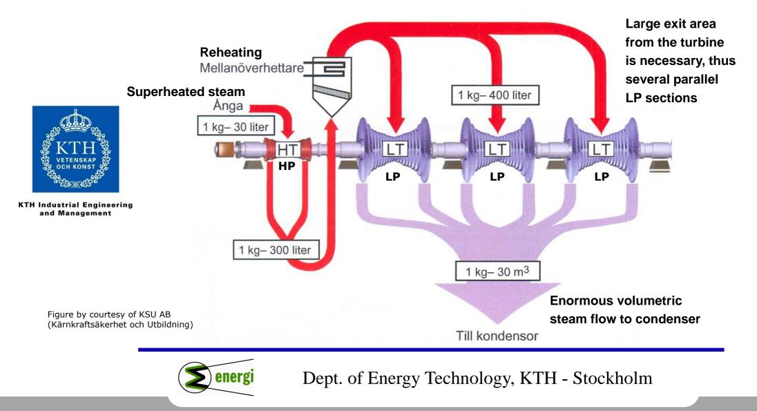
a-b expansion genom HT-turbinen b-c fuktavskiljning och överhettning c-d expansion genom LT-turbinerna
