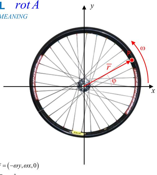
$$\oint_{L} \overline{A} \cdot d\overline{r} = \iint_{S} rot \overline{A} \cdot d\overline{S}$$
